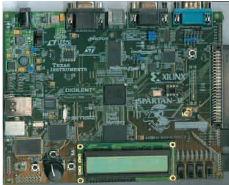
Рис. 3.1. Зовнішній вигляд інструментального модуля Xilinx Spartan-3E
